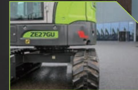
Eines der Highlights des ZE27GU ist der Null-Schwenk des Hecks, dessen Schwenkradius im voll ausgefahrenen Zustand die Breite des Gleises nicht überschreitet.
