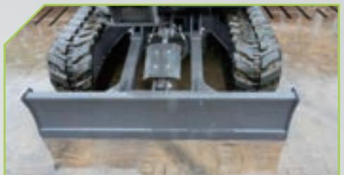
Das Hydrauliksystem der Planierraupe ist mit einer Schutzeplatte ausgestattet, um schwierigen Arbeitsbedingungen gerecht zu werden und gleichzeitig den Zylinder und die Leitungen zu schützen.
