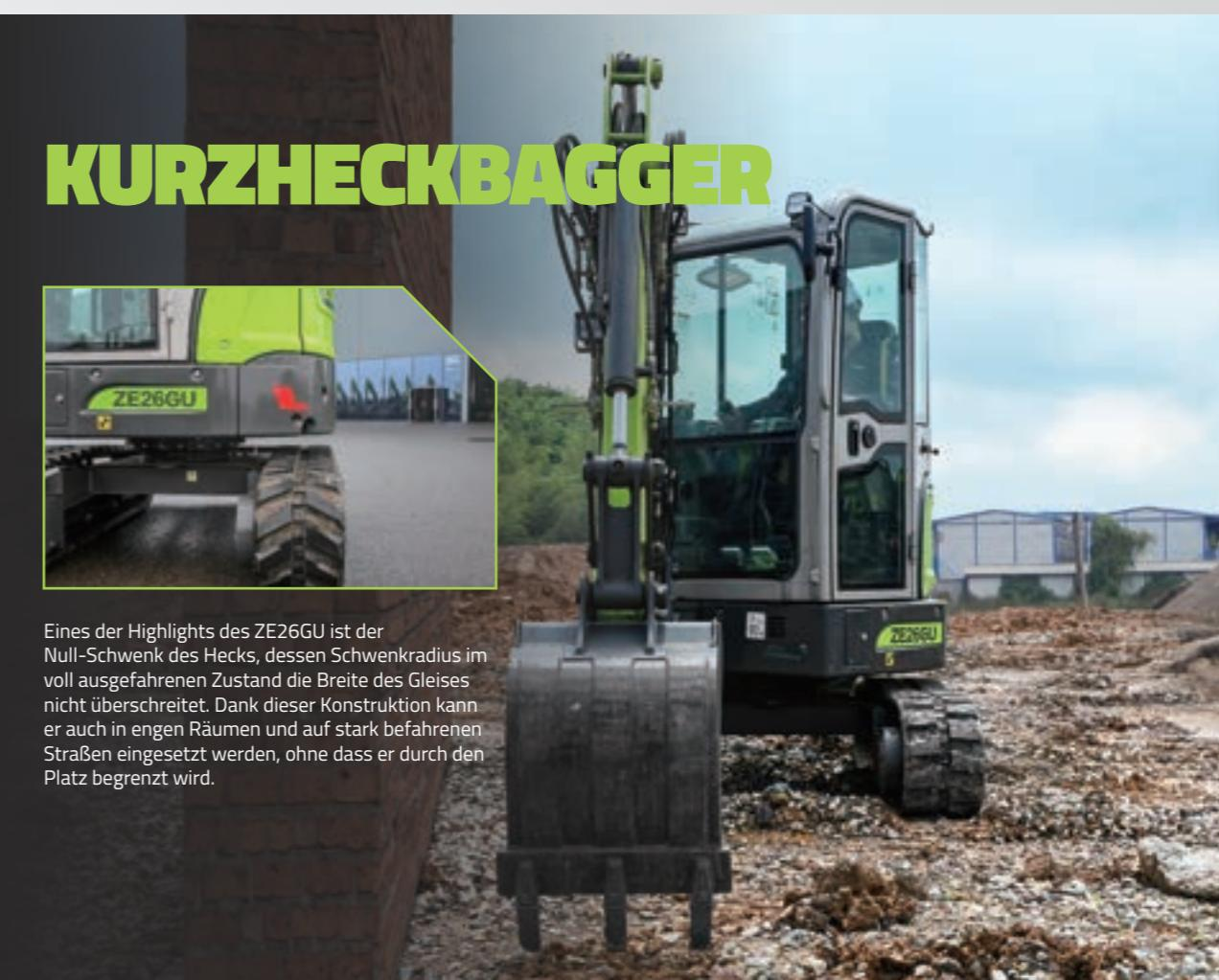
Eines der Highlights des ZE26GU ist der Null-Schwenk des Hecks, dessen Schwenkradius im voll ausgefahrenen Zustand die Breite des Gleises nicht überschreitet. Dank dieser Konstruktion kann er auch in engen Räumen und auf stark befahrenen Straßen eingesetzt werden, ohne dass er durch den Platz begrenzt wird.
