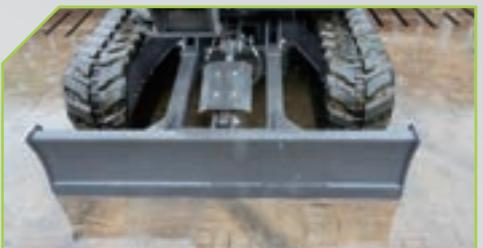
Das Hydrauliksystem der Planierraupe ist mit einer Schutzplatte ausgestattet, um schwierigen Arbeitsbedingungen gerecht zu werden und gleichzeitig den Zylinder und die Leitungen zu schützen.
